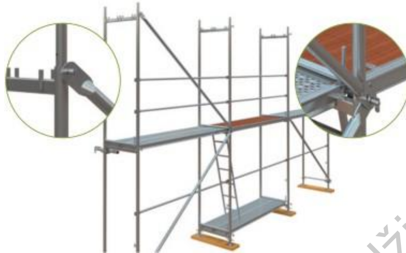
13 pav. Skersinės įstrižainės montavimas antrame aukšte
